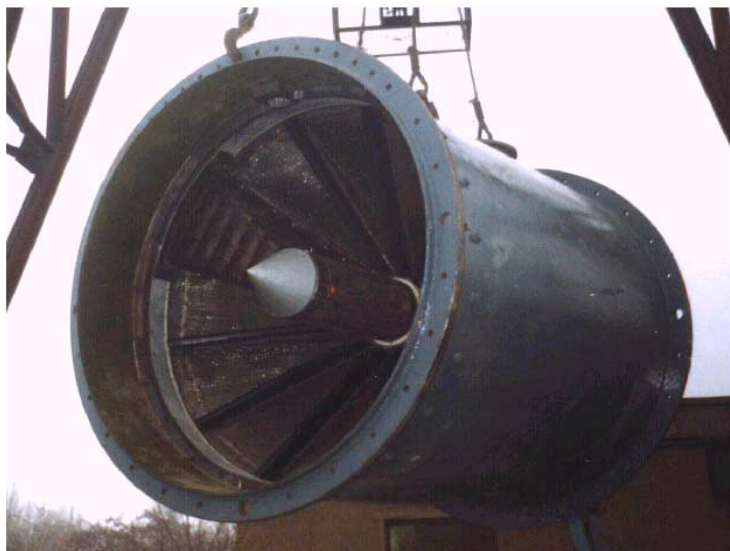
Рис. 1 Фильтр ФПО-1600 на погрузке водоснабжения мусор попадает через открытые участки (градирни, сбросные колодцы, отстойники)
