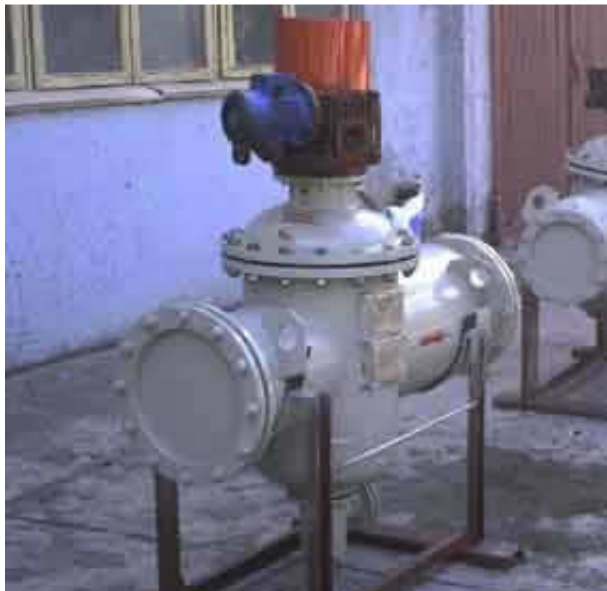
Рис. 3. Фильтр серии ФСВ
