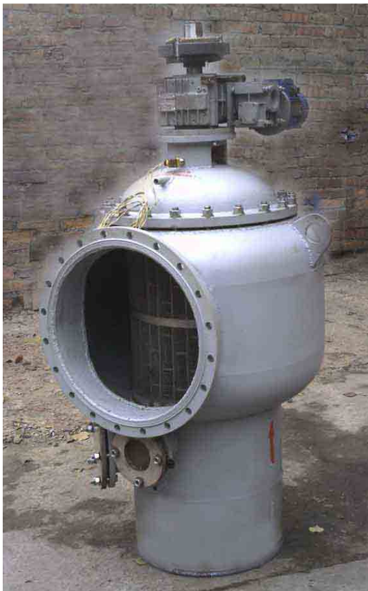
Рис. 6. Фильтр серии ФСЦ
