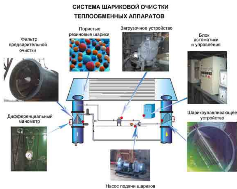
Рис. 1 Схема СШО Океанмашэнерго
